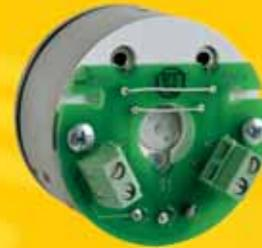
Circuito de conexión con conexiones AMP
