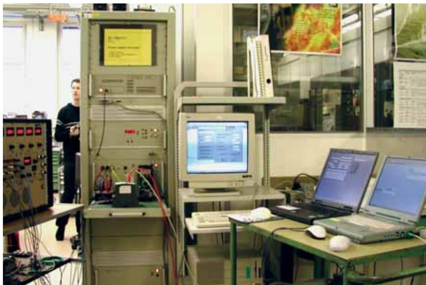
Medición del comportamiento de los aparatos en caso de caídas y oscilaciones de tensión o de interrupciones de corta duración del suministro de energía auxiliar.
