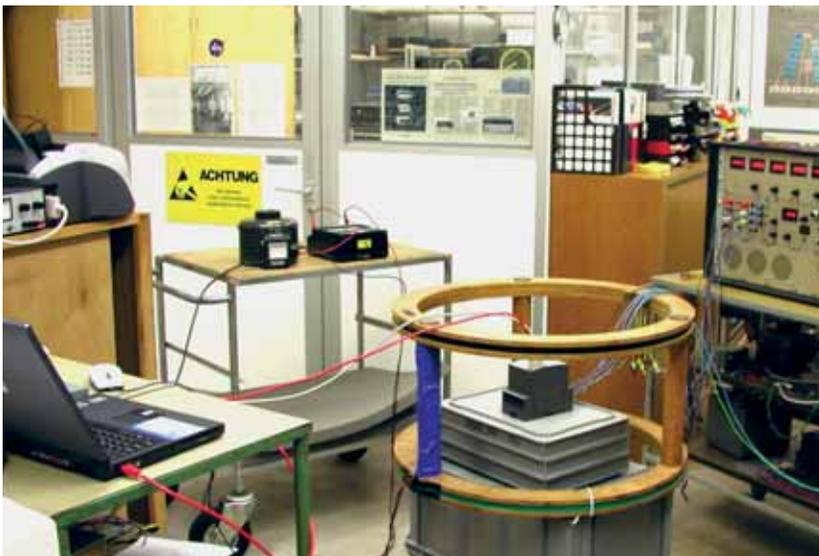
Determinación del comportamiento del aparato bajo la influencia de un campo electromagnético externo creado con una bobina de Helmholtz.
